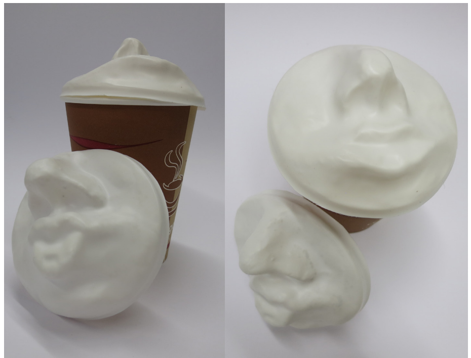
Ergebnisse des Tiefziehens mit Polystyrolfolie (0,5 mm Stärke)
